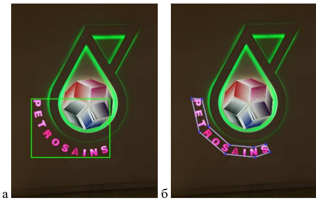
Рис. 3. Сравнение методов выделения объекта: а) традиционный (прямоугольник), б) новый (многоугольник)
