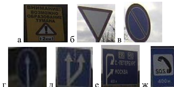
Рис. 3. Примеры классов дорожных знаков: а) Предупреждающие знаки, б) Знаки приоритета, в) Запрещающие знаки, г) Предписывающие знаки, д) Знаки особых препятствий, е) Информационные знаки, ж) Знаки сервиса
