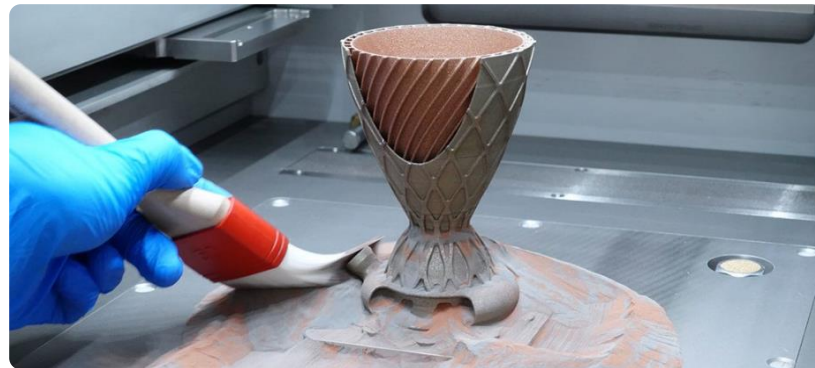
Разрезная модель камеры сгорания ракетного двигателя с интегрированными каналами охлаждения в уменьшенном масштабе, выполненная из материалов CW106C и 1.2709. [1]
