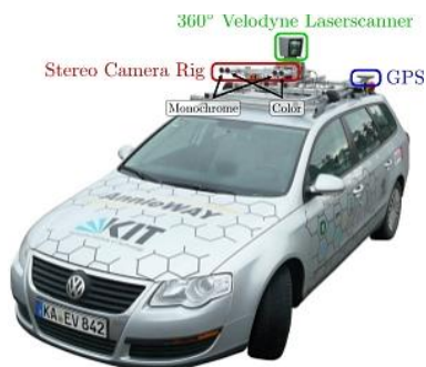
Рис. 1. Автомобиль с установленным на нем оборудованием, использовавшийся для сбора датасета KITTI
