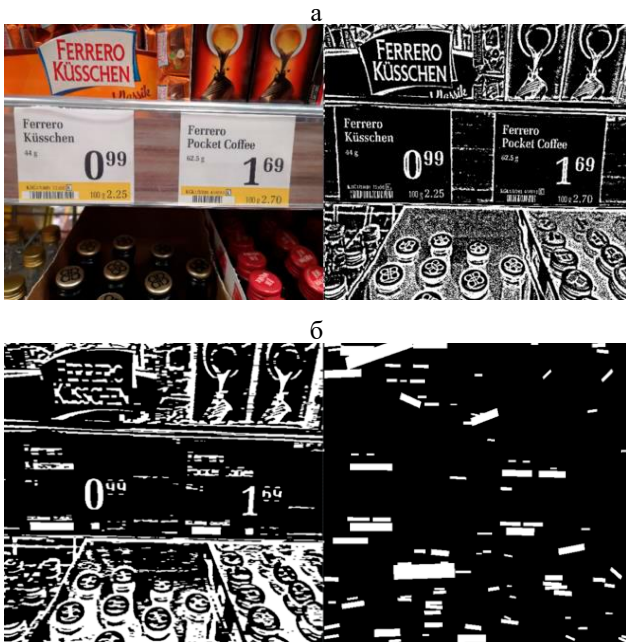
Рис. 7. а) Входное изображение (слева) и бинаризованное (справа); б) Результаты выполнения морфологических операций (слева) и заливки контуров после нее (справа)
