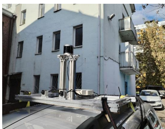
Рис. 4. Lidar Helios 32 ,установленный на крыше машины
