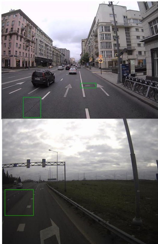
Рисунок 5. Пример работы VGG в задаче детектирования трещин и дорожных заплаток на асфальте
