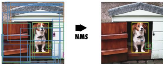
Рисунок 7 – Фильтрация нерелевантных ограничивающих рамок при помощи NMS
