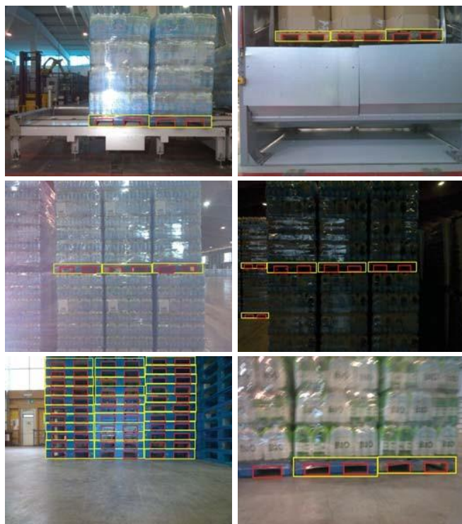
Рис 4 – Примеры определения лицевых сторон и карманов поддонов с использованием Faster R-CNN
