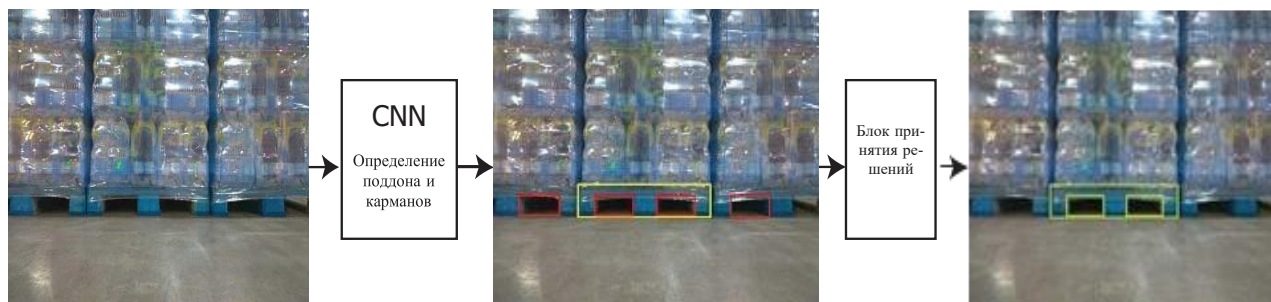
Рис 1 – рассматриваемый пайплайн для автоматического детектирования поддонов
