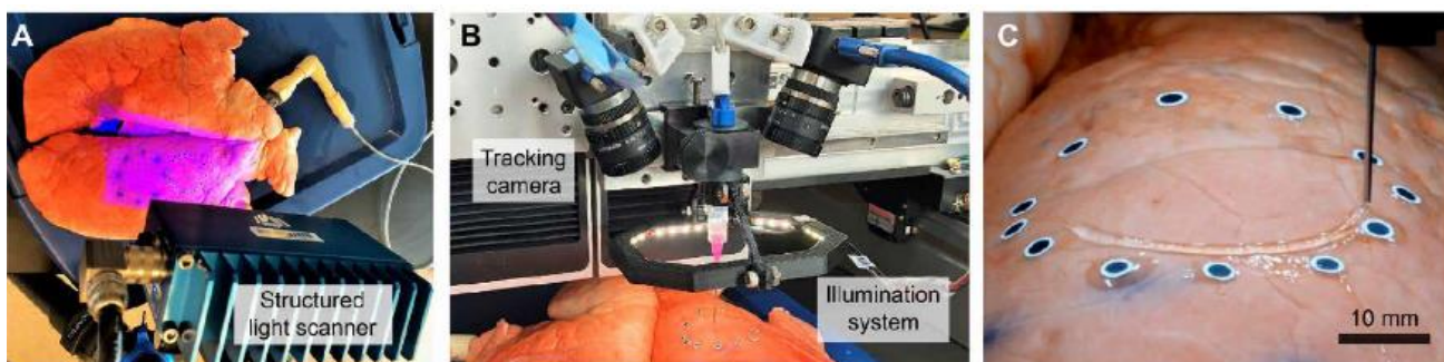
Рисунок 6 – Последовательность работы установки: получение 3D-модели структурированным светом; биопечать по криволинейной поверхности с отслеживанием движения с помощью телекамер
