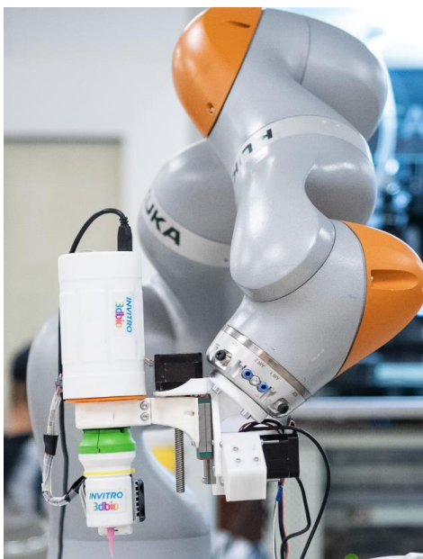
Рисунок 88 – Фотография робототехнической системы для печати на теле пациента на базе манипулятора KUKA iiwa R820
