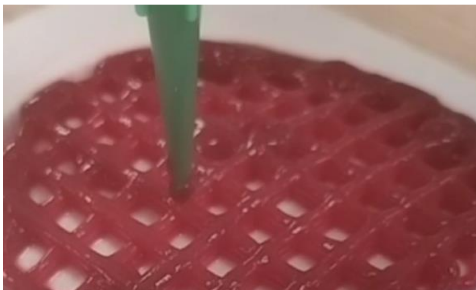
Рисунок 95 – Процесс печати на пластиковом фантоме
