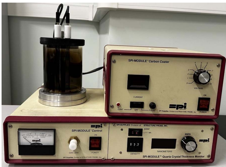
Рисунок 2.6 – Установка SPI Carbon Coater для напыления углерода
