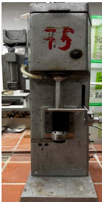
Рисунок 2.18 – Лабораторная механическая флотомашина ФМЛ-0,3 «Механобр»
