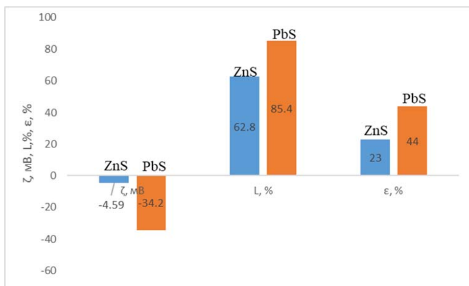
Рисунок 4.4 – Диаграмма извлечения в концентрат, относительной адсорбции БутКс-К в условиях флотации в трубке Халлимонта в сравнении с \zeta -потенциалом ультратонких частиц при pH исх NaOH= 8,0
