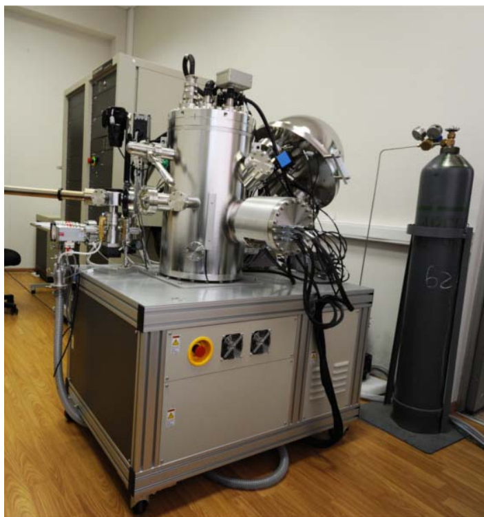
Рисунок 2.10 – рентгеновский фотоэлектронный спектрометр PHI5000VersaProbeII (ULVAC-PHI)
