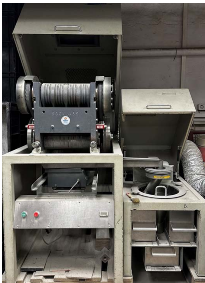
Рисунок 2.2 – Дробильная установка Rocklabs Ltd с сократителем RSD
