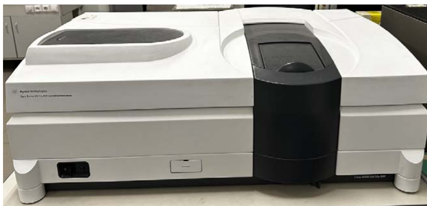
Рисунок 2.12 – УФ спектрометр UV-NIS Cary 6000i
