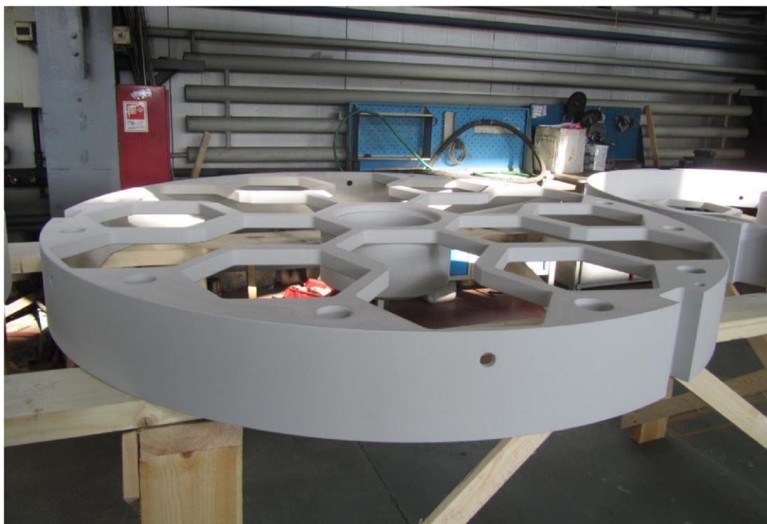
Рисунок 29 – Деталь (диаметр 3 м.) внутреннего корпуса реактора, изготовленного из сплава АК8, для хранения радиоактивных отходов с ПЭО покрытием на основе аморфного \text{SiO}_2 [115]
