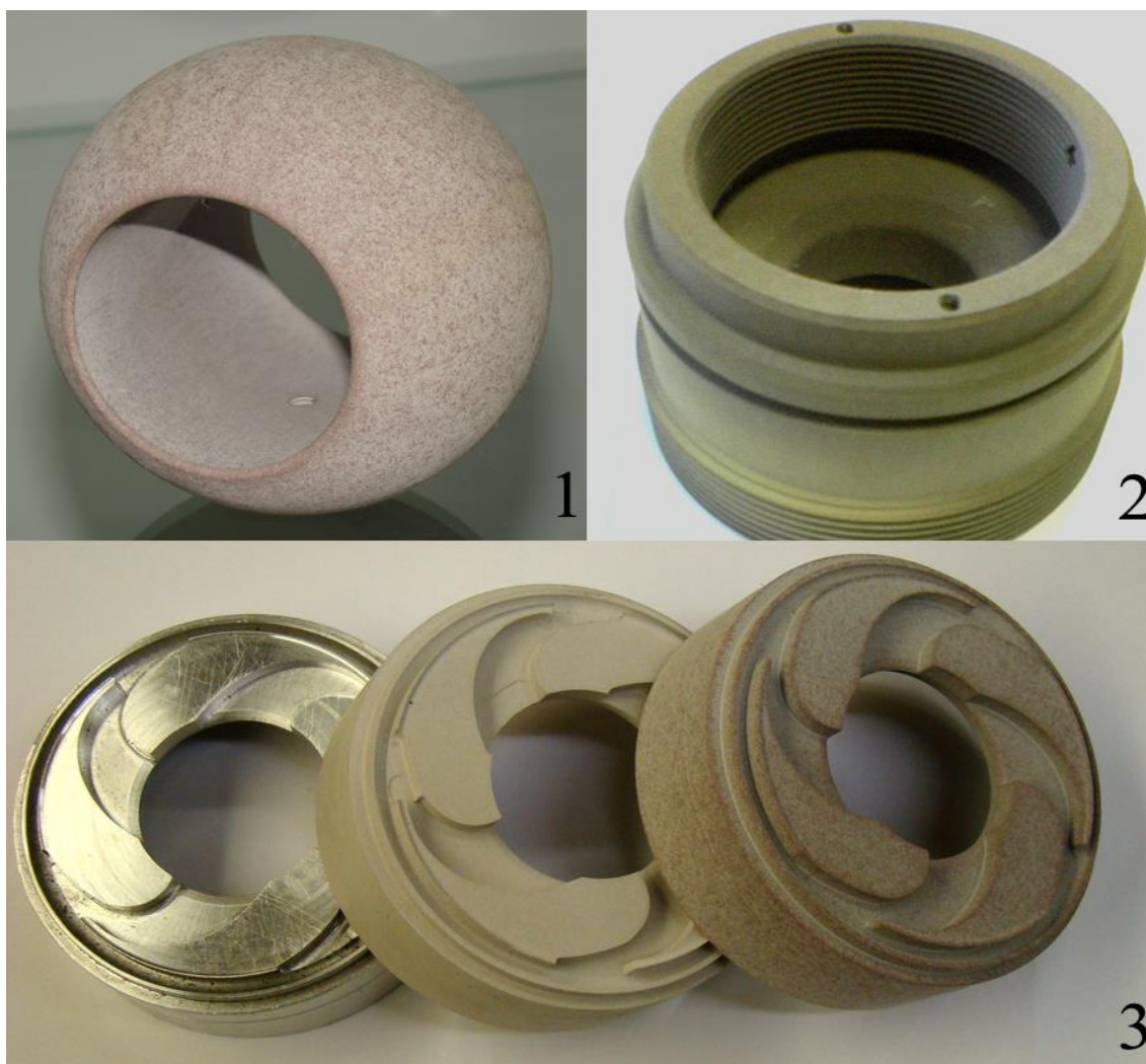
Рисунок 27 – Антикоррозионные износостойкие покрытия, полученные плазменно-электролитическим оксидированием на изделиях из алюминиевых сплавов: 1) обратный шаровой клапан; 2) пробка шарового крана; 3) рабочие колеса центробежных насосов [115]
