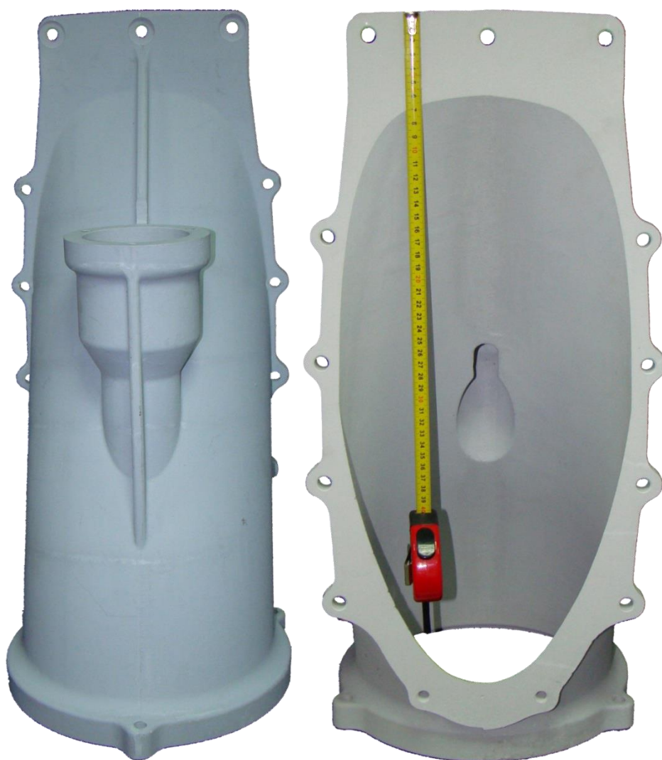
Рисунок 30 – Корпус водометного движителя, изготовленного из сплава АД31, с ПЭО покрытием на основе аморфного \text{SiO}_2 [115].
