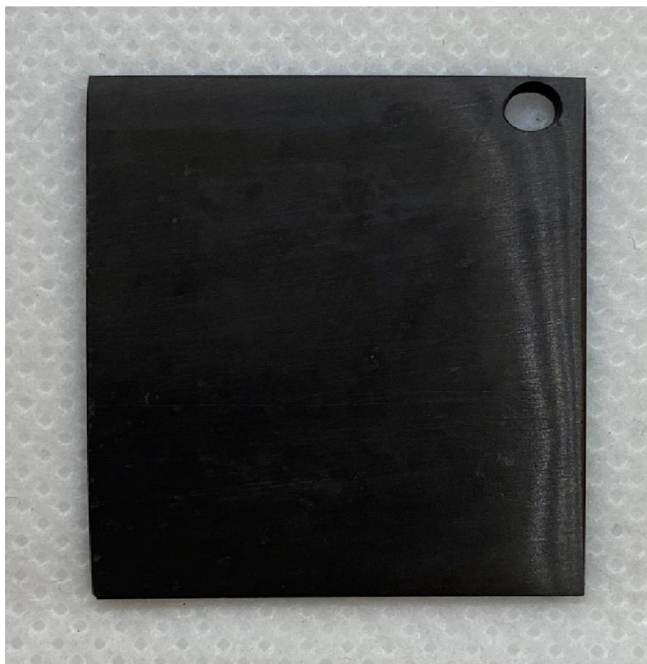
Рисунок 43 – Типичный вид пленки, первоначально образующейся на силумине АК12М2 в модельных водных растворах pH 8,3 и 9,5 [140]
