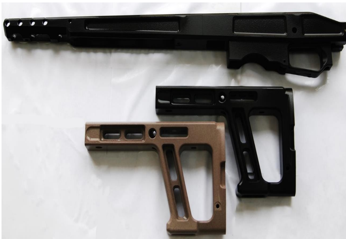
Рисунок 26 – Декоративно-защитные плазменно – электролитические покрытия, нанесенные на корпуса оружия [115]
