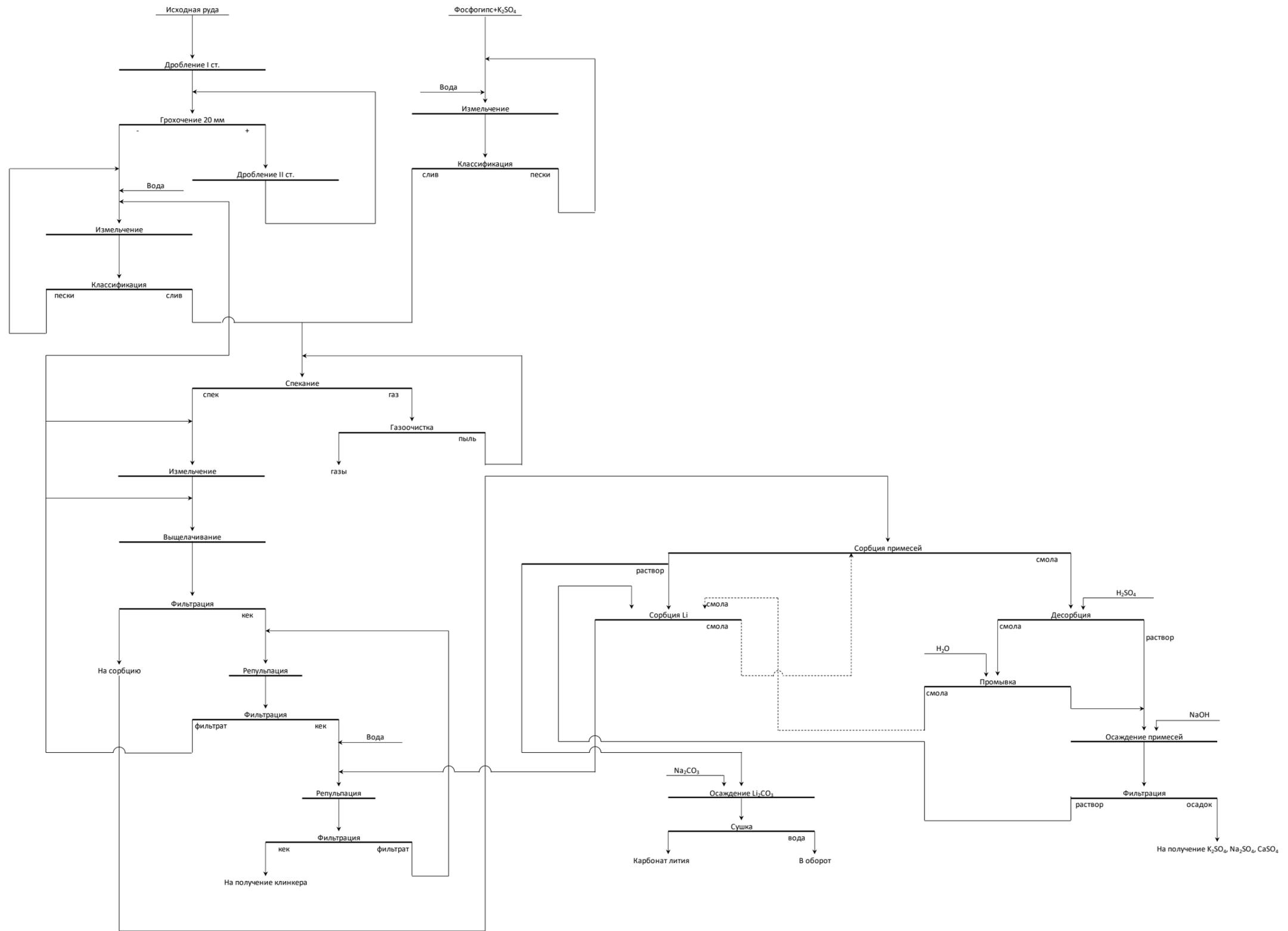
Принципиальная технологическая схема получения карбоната лития
